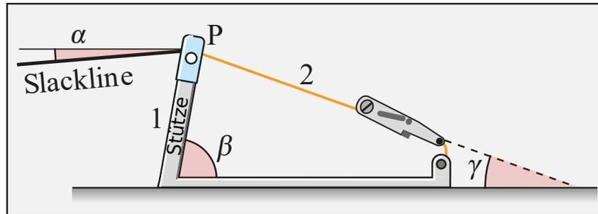
$\alpha = 5^\circ$ ,  $\beta = 80^\circ$ ,  $\gamma = 20^\circ$ . Die Slackline wirkt mit einer Kraft von 3 kN. Berechnen sie alle Kräfte auf die Stütze der Slackline. Gehen Sie dazu wie folgt vor:
