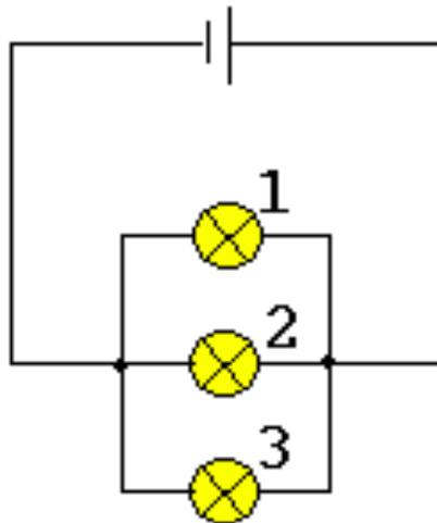
Was geschieht, wenn man in der folgenden Schaltung mit lauter gleichen Lampen die Lampe Nr. 3 heraus schraubt und die Spannung gleich bleibt?
