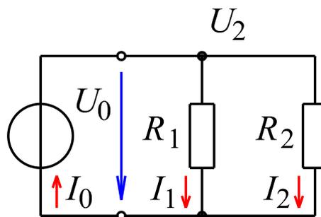
$R_1 = 100\Omega$ ,  $R_2 = 220\Omega$ , Netzteil 12 V, Strom?
