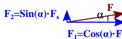
Die Kraft mit Betrag  $F$  soll zerlegt werden in eine Kraft  $F_1$ , die Winkel  $\alpha$  einschliesst mit  $\vec{F}$  und Kraft senkrecht dazu. Für  $\alpha < 45^\circ$  ist  $F_1 < F_2$ . Dies erlaubt die Zuordnung:
