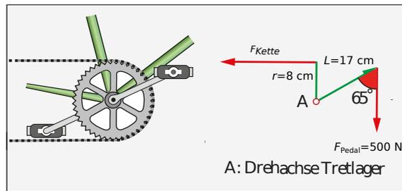
Länge Pedale  $L = 17 \text{ cm}$ , Radius Kettenblatt  $r = 8 \text{ cm}$ , Kraft Pedale  $500 \text{ N}$ , Winkel  $\alpha=65^\circ$ . Wie gross ist die Kraft an der Kette?
