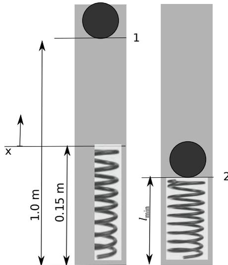
Eine Kugel ( $m = 0.1 \text{ kg}$ ) fällt aus einer Höhe 1 m auf eine Feder der Länge  $l_0 = 15 \text{ cm}$  und  $D = 150 \text{ N/m}$ .
