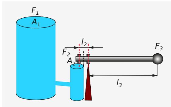
Die Laborpresse erzeugt beim Kolben 1 eine Kraft, wie 2 Elefanten (15t). Laborpresse  $A_1 = 52.8 \text{ cm}^2$ ,  $A_2 = 0.9 \text{ cm}^2$ .
