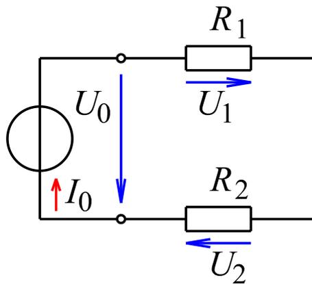
$R_1 = 100\Omega$ ,  $R_2 = 220\Omega$ , Netzteil  $U_0 = 12\text{ V}$ , Strom?
