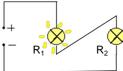
Wir betrachten zwei verschieden 'starke' Lämpchen mit den Widerstand  $R_1$  und  $R_2$ , die mit der Quellspannung  $U_0$  betrieben werden. .
