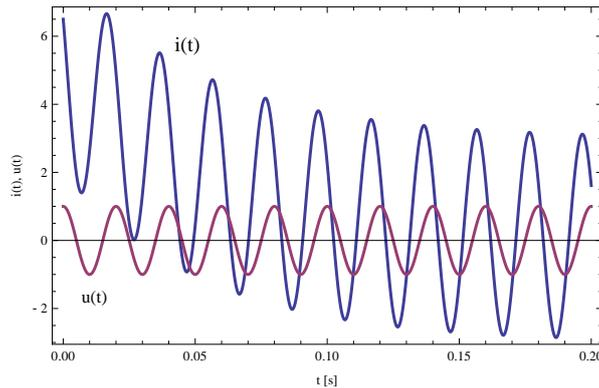
Abbildung 14.1: Ein RCL-Kreis wird an eine Wechselstromquelle angeschlossen. Zunächst schwingt sich der Kreis ein [0-0.10 s]. In dieser Zeit ist die transiente Lösung wichtig. Danach schwingen Strom und Spannung mit der selben Frequenz aber mit verschiedenen Amplituden und phasenverschoben. Das ist die stationäre Lösung.
