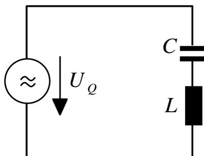
Berechne den elektrischen Strom im eingeschwungenen Zustand für den Schaltkreis, der mit einer Wechselspannung
