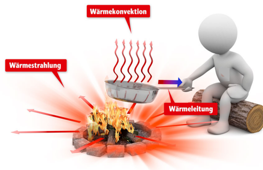
Abbildung 32.1: Die drei Arten der Wärmeübertragung
