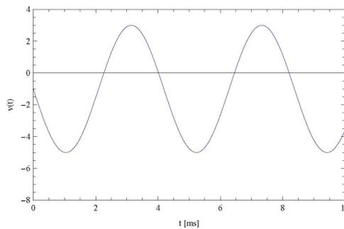
Die Kugel fällt, d.h. die Geschwindigkeit ist negativ und nimmt im Fall (betragsmässig) zu. Sie erreicht ein Maximum, bevor sie durch die Feder gebremst und nach oben beschleunigt wird. Wir beobachten: Bei den (betragsmässig) höchsten Geschwindigkeiten, verändert sich die Geschwindigkeit für einen Moment nicht, mathematisch ausgedrückt:
